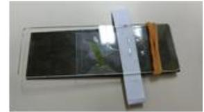
黒いプラスチック板に穴をあけ、そこにビーズ球を入れ、レンズとし、プラスチックのしなりを利用してピント合わせができるようにした。また、プラスチック製のカバーガラスを使い、安全面にも考慮した。今回は観察や入手が容易なオオカナダモを試料としたが、今後は参加者の興味を引けるような試料を探していく必要がある。
