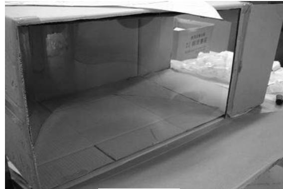
スピーカーを放物線の軸上で原点から 65cm 離して設置し、振動数 150Hz でダンボール上に 10cm 間隔で設けた測定点 18 点で音の大きさを測定した。
