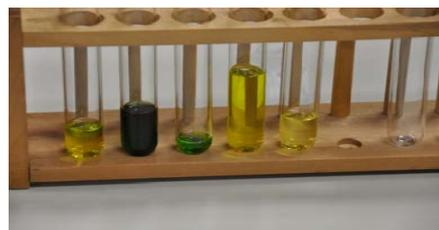
まず黄色のβ-カロテンが流出する(写真上左)、次に緑色のクロロフィルa、bが流出する(写真上中)、続いて、ルテイン、ピオラキサンチン、・・・の順で黄色色素が流出する。それを試験管に分取する(写真上右)
