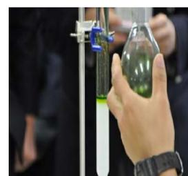
アセトン抽出したホウレンソウ色素・沈殿しているのは脱水剤として加えた無水硫酸ナトリウム(写真上左)、ロータリーエバポレーターを用いて濃縮したサンプル(写真上中)、カラムにサンプルをチャージ(写真上右)
