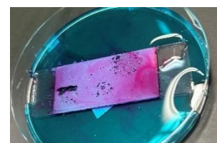
図8:メチレンブルーに浸した TiO 2 膜
