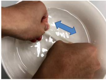
ガム膜を薄く延ばす ガム膜を練る人は統一する 室温 19.0°C±0.5°C
