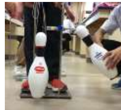
図1①;反発係数の測定装置 図1②;反発係数の測定
