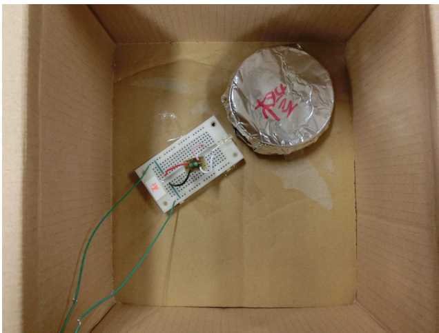
図6 LED 橙とシャーレを入れた段ボール隙間をアルミ箔で覆うことで遮光している。
