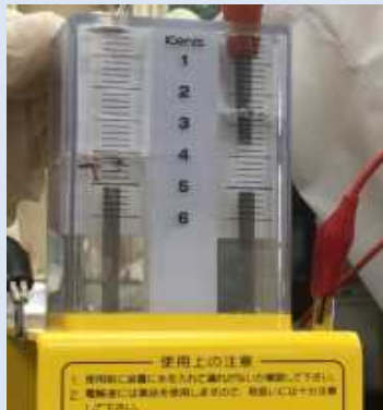
(図1) 陰極付近の溶液にイソジンを滴下した様子
