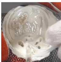
図4 気体の注入によってできた空気の通り道
